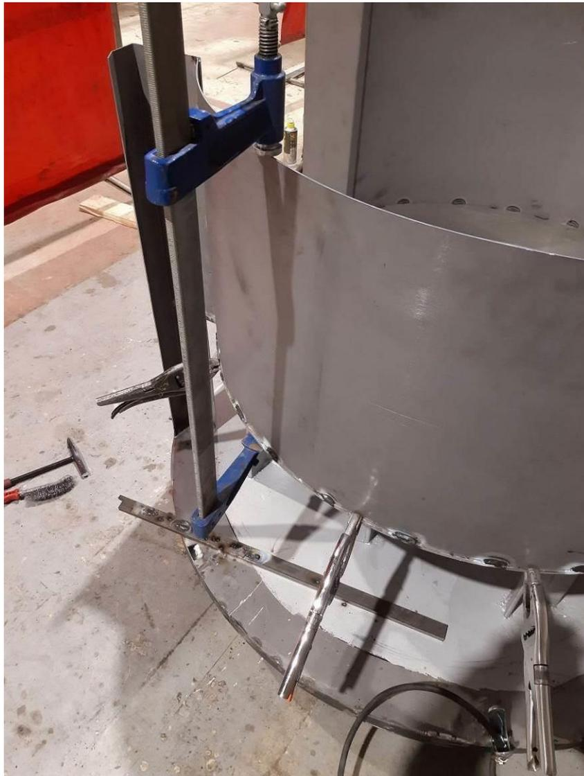
La virole est posée que le fond de la chambre de cuisson, à 5mm du bord, afin de pouvoir faire un cordon par l'extérieur. Une astuce pour le positionnement de la virole consiste à placer des pincettes étaux sur la circonférence du fond de la chambre de cuisson. Elles doivent mordre sur environ 5mm. Elles servent ainsi de butées à la virole, qui prend « naturellement » sa place dans cet espace.
