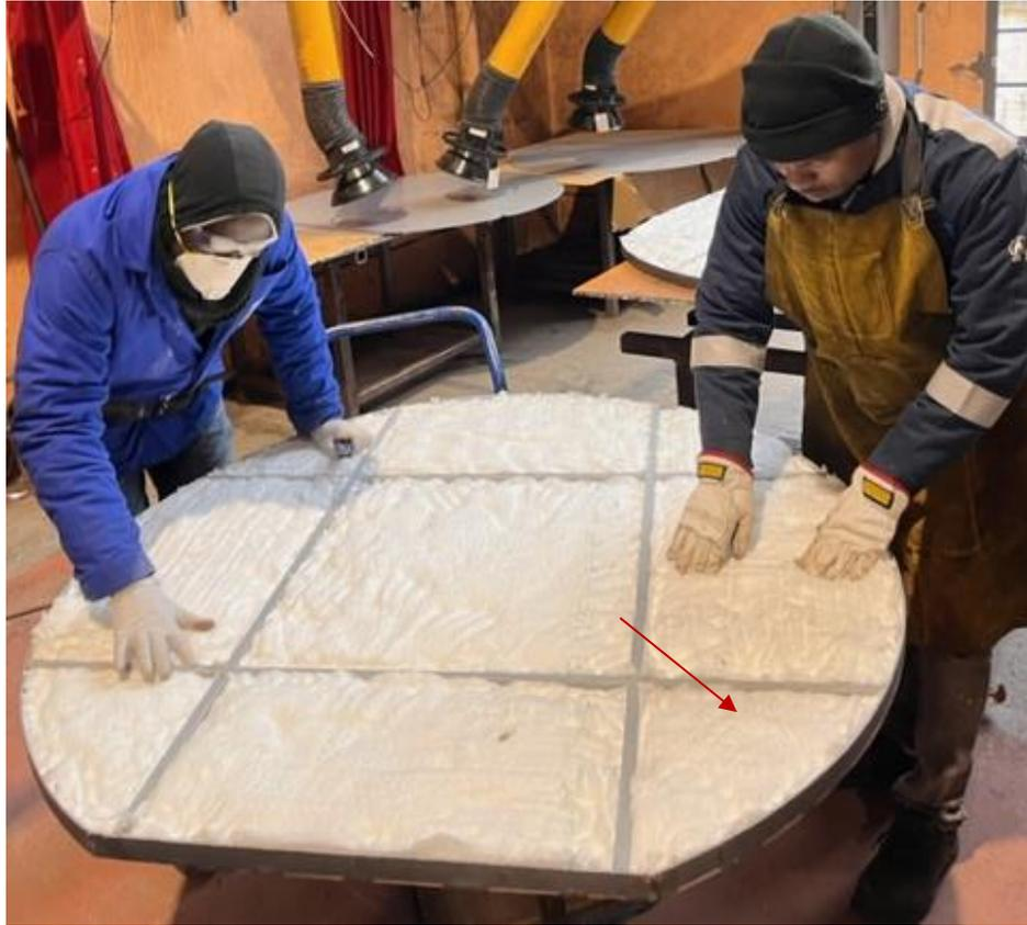
Couper l'isolant haute température en fibre de céramique avec un masque et de préférence dans un espace ventilé
