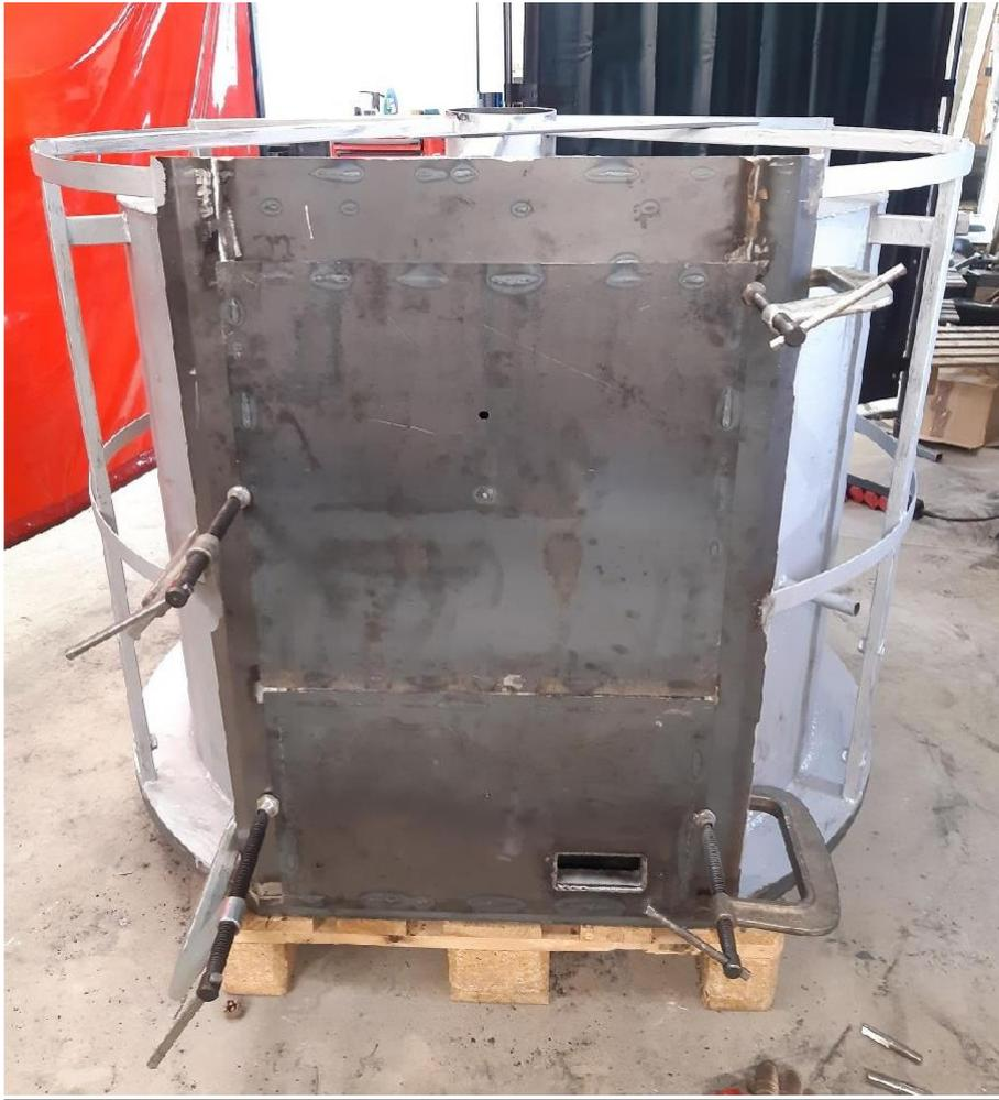
Positionnement vertical de la porte : disposer une cale d'épaisseur sous chaque porte (épaisseur égale ou légèrement supérieure à la moitié du jeu vertical entre la porte et l'encadrement de porte).
