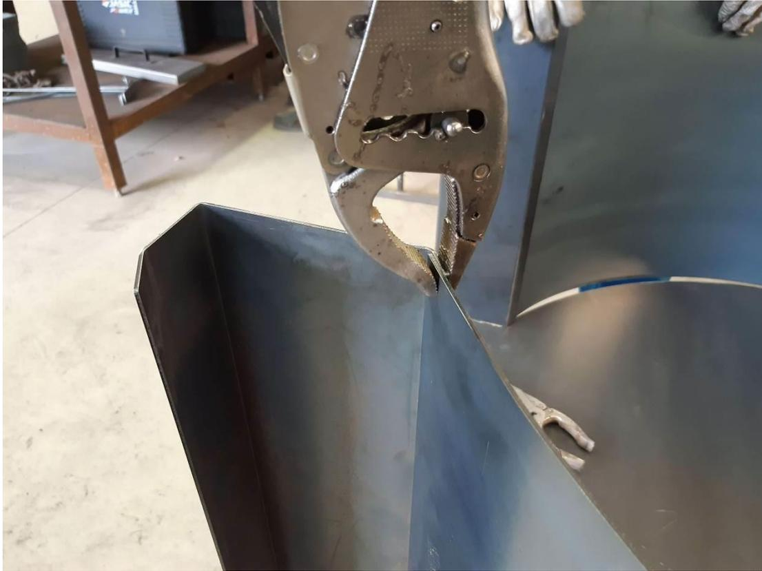
Brider ensuite à l'aide d'un serre-joint vertical de manière à ce que la virole plaque bien contre le fond, et pointer. On peut déplacer le serre-joint au fur et à mesure que l'on « avance » en pointant sur toute la périphérie. Commencer d'un bord vers l'arrière, et d'un autre bord vers l'arrière.
