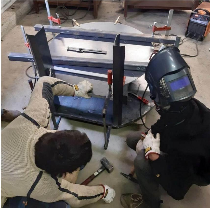
**Le positionnement de la table sur le double fond** doit être fait précisément. Les deux « faces » doivent être bien alignées, et la table centrée latéralement. Au final on doit avoir une ouverture bien rectangulaire au niveau de l'espace de la porte du foyer, et que les tableaux de portes soient bien verticaux (qu'ils ne penchent ni vers l'avant ni vers l'intérieur du four).
